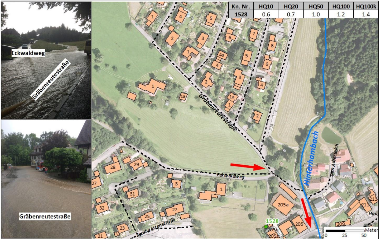
Abbildung 2.30: Außenbereich Eckwaldweg, Lageplan mit Fotos vom Starkregenereignis am 07.06.2016 und den abgeleiteten Fließwegen
