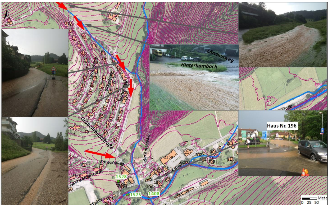
Abbildung 2.31: Außenbereich Hinterhambach, Lageplan mit Fotos vom Starkregenereignis am 07.06.2016 und den abgeleiteten Fließwegen
