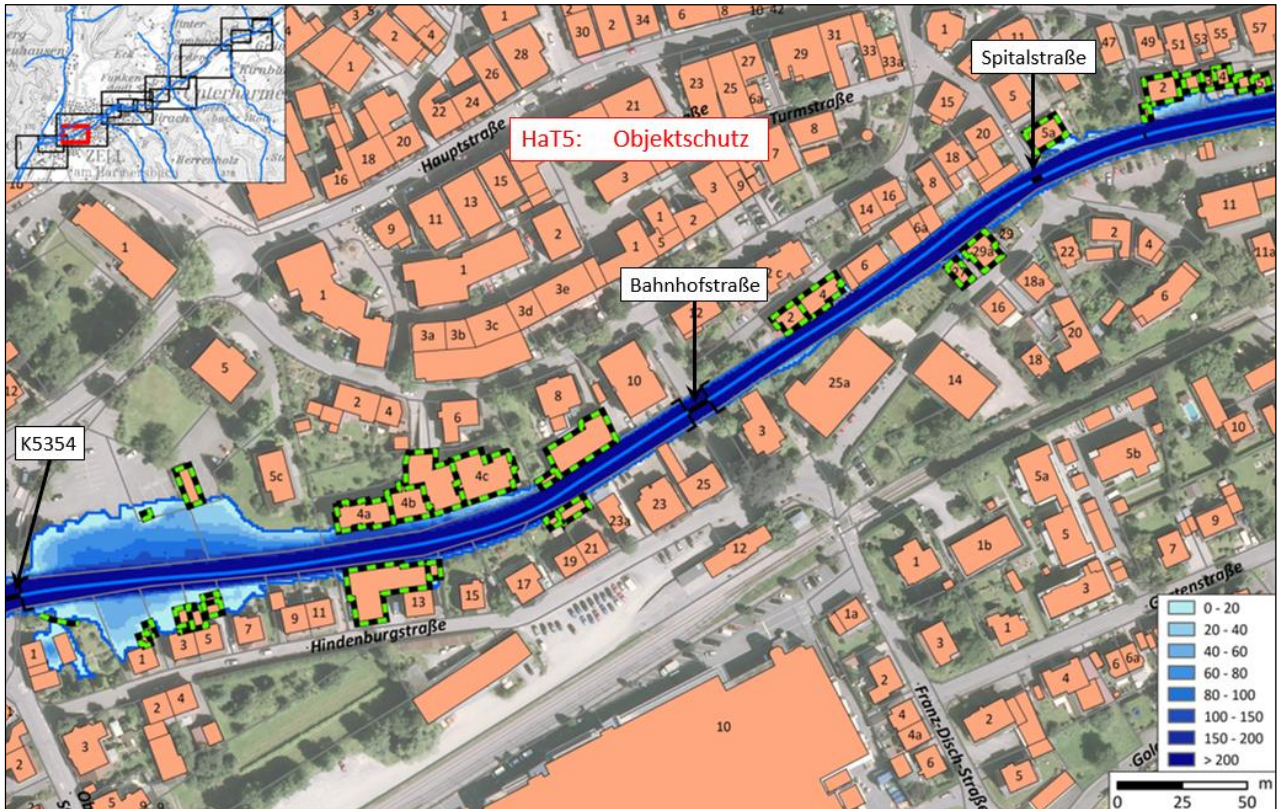
Abbildung 3.10: Überflutungstiefen am Harmersbach (Detailbereich TB5-D1) beim HQ_{100} im Plan-Zustand und vorgeschlagene HWS-Maßnahmen
