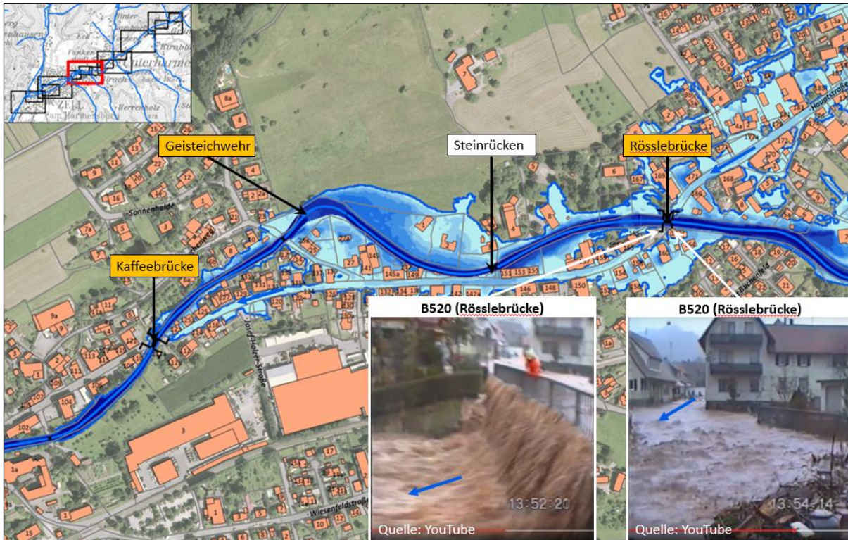
Abbildung 2.13: Überflutungstiefen HQ_{100} im Ist-Zustand und Vergleich mit der Situation beim HW 1991 am Harmsbach (Teilbereich 4)
