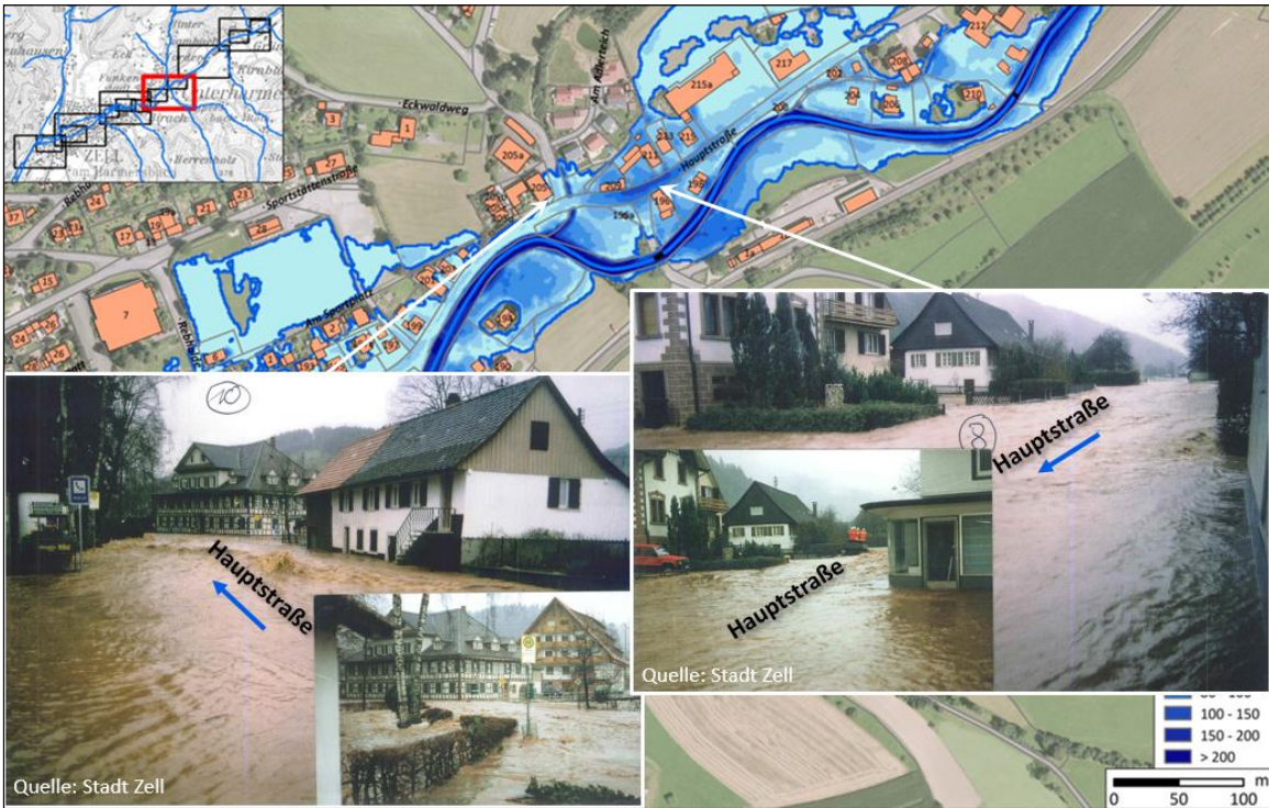
Abbildung 2.10: Überflutungstiefen HQ 100 im Ist-Zustand und Vergleich mit der Situation beim HW 1991 am Harmersbach (Teilbereich 3)
