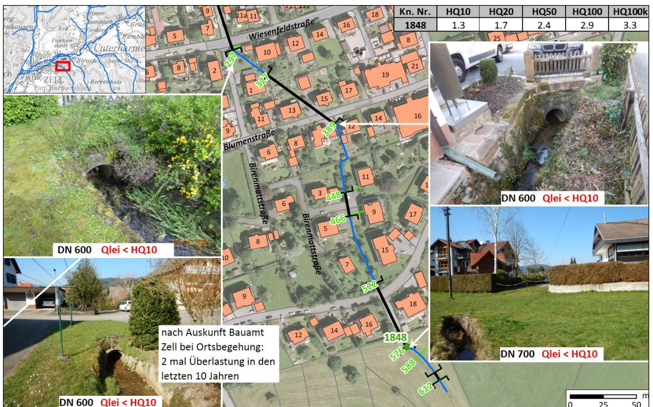
Abbildung 2.26: Knopfholzbächle, Teil 1 - Lageplan mit Querprofilen und Auswertung der hydraulischen Berechnungen
